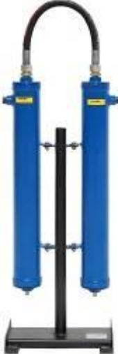
Фильтрационный модуль предназначен для тонкой очистки сжатого воздуха и различных газов, от аэрозолей масла и влаги, а также от твердых частиц размером более 10 мкм. Обеспечиваемое остаточное содержание аэрозоля масла - менее 16 мг/м<sup>3</sup>. Используется в системах пневмоуправления и автоматики, пневмоприводе устройств и инструмента для окраски поверхностей распылением.
