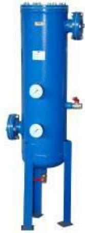
Фильтрационный модуль предназначен для тонкой очистки сжатого воздуха и различных газов, от аэрозолей масла и влаги, а также от твердых частиц размером более 10 мкм. Обеспечиваемое остаточное содержание аэрозоля масла - менее 16 мг/м<sup>3</sup>. Используется в системах пневмоуправления и автоматики, пневмоприводе устройств и инструмента для окраски поверхностей распылением.
